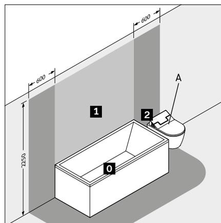
A SensoWash (IP X4) darf in Bereich 2 hineinragen
